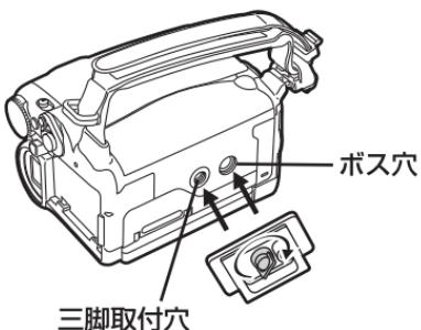
2 カメラ台をビデオカメラに取り付け、ねじで締めて固定する
