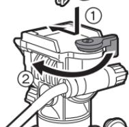
3 カメラ台を三脚に取り付け、カメラ台ストッパーを「LOCK」側へ
